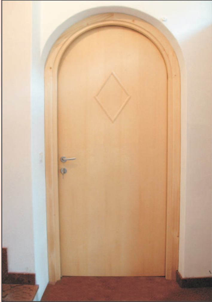
Porta in Abete massello 'invecchiata' con giunzione a penna, profili contrapposti e specchi bugnati.
